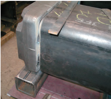
両側面に組み立て溶接を行う
