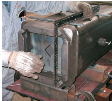
縦横各2ヶ所の直角度を確認する
