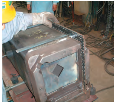
縦横各2ヶ所の直角度を確認する
