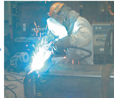
本溶接を行い、縦横各2ヶ所の直角度を確認する
