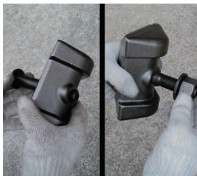
コーナークリッパーとボルトを組み立てる
